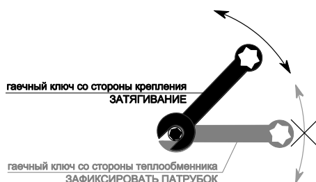
Рис. 5. Подключение к системе подачи теплоносителя
